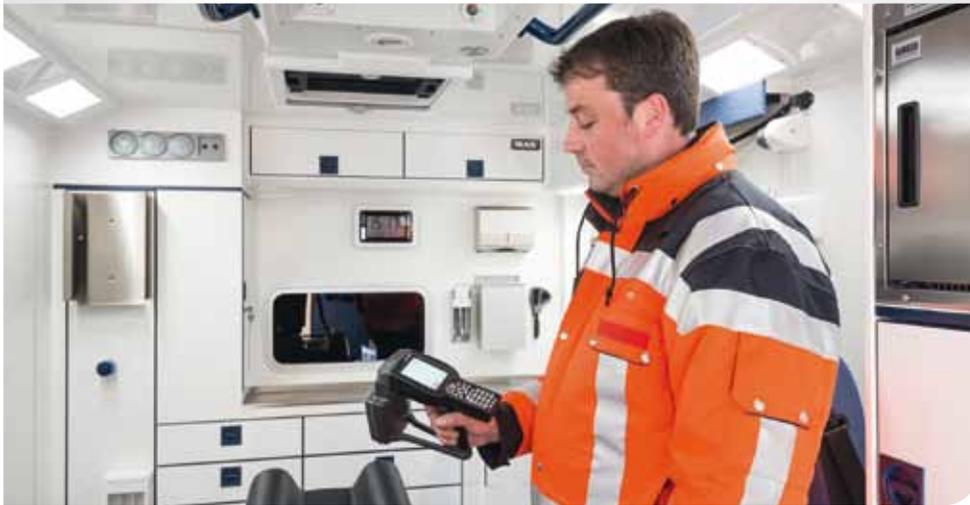
**WAS Smart Check hat immer alles unter Kontrolle.** Die Ausrüstungskontrolle mit RFID gibt Rettern entscheidend mehr Zeit und Sicherheit. Das autarke System für alle RTW überprüft Verbrauchsgüter sowie medizinische Geräte an Bord in wenigen Minuten: auf ihre Vollständigkeit, auf Verfallsdaten, Wartungsintervalle und die richtige Fahrzeugzuordnung. **WAS Smart Check ist eins der innovativen WAS Assist Systems, die den Arbeitsalltag von Einsatzkräften vereinfachen.**
